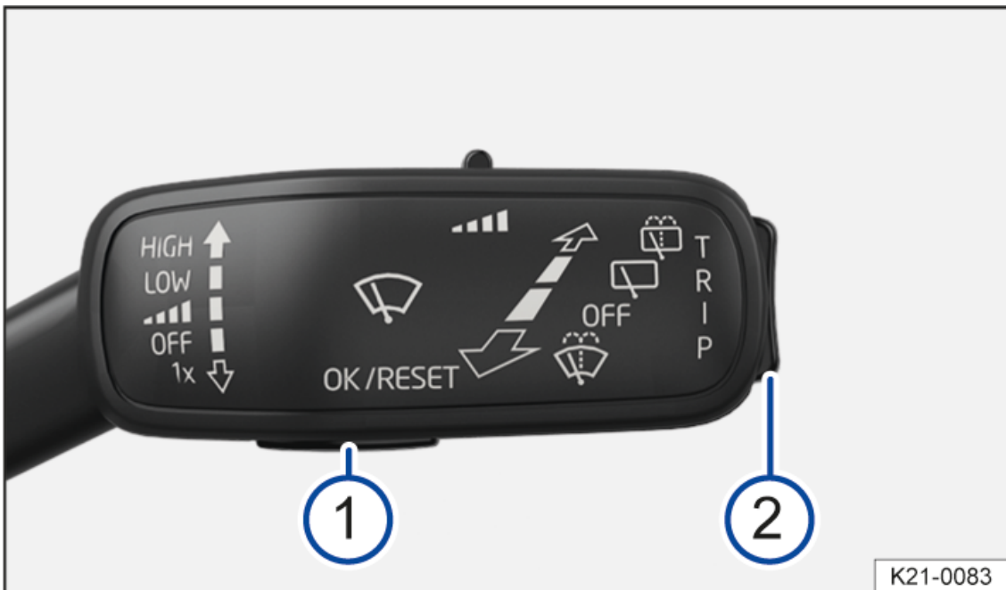
Fig. 3 Te kolona e timonit djathtas: Butonat te leva e fshirëseve të xhamave.
