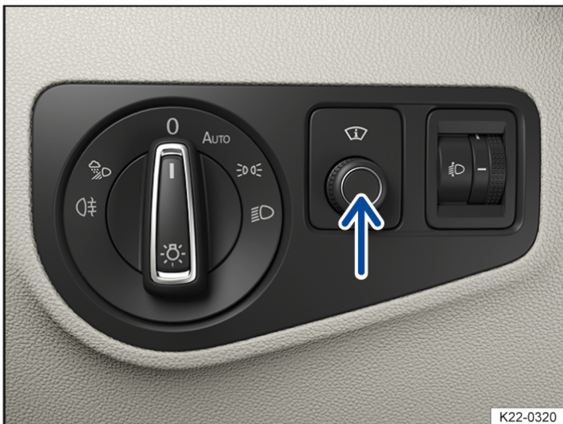
Fig. 1 Pranë timonit: Rregullatori për ekranin Head-up (Shigjetë).
