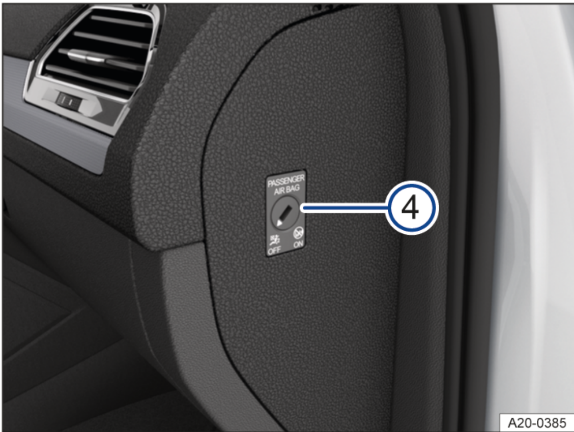
Fig. 2 Kur dera e pasagjerit përpara është e hapur (automjetet me timon në të majtë): Çelësi në panelin e instrumenteve (për automjetet me timon në të djathtë vlen e njëjta gjë por në krahun tjetër).
