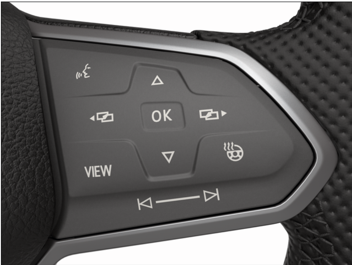
Fig. 2 Ana e djathtë e timonit multifunksional: Përdorimi i kruskotit analog (varianti 2).
