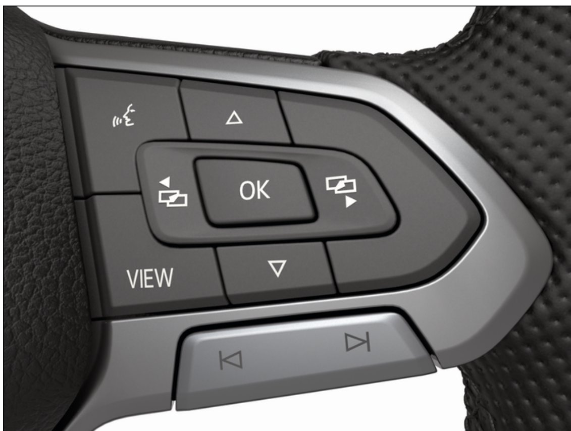
Fig. 1 Ana e djathtë e timonit multifunksional: Butonat për përdorimin e menye dhe të treguesve të informacionit në kruksotin dixhital Pro Version.
