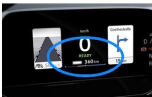
O motor elétrico é silencioso. O indicador à esquerda no painel de instrumentos (medidor de potência) indica se o automóvel se encontra desligado “OFF” ou pronto para funcionamento “READY”.
