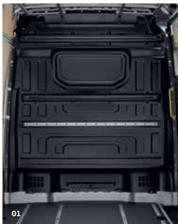
01 Преградна стена без прозорец. Преградната стена съгласно DIN 75410-3 е напълно затворена. Допълнително се предлага отделение под тавана над кабината – при висок таван то е серийно. | KA |
