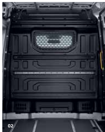
02 Преградна стена с прозорец и защитна решетка. Наклонът на стъклото предотвратява отражения в зрителното поле на водача. Решетката предпазва стъклото, водача и пътника до водача – например при внезапно спиране. За прозореца се предлагат два варианта: фиксирано стъкло или плъзгащо се стъкло. | KA |
