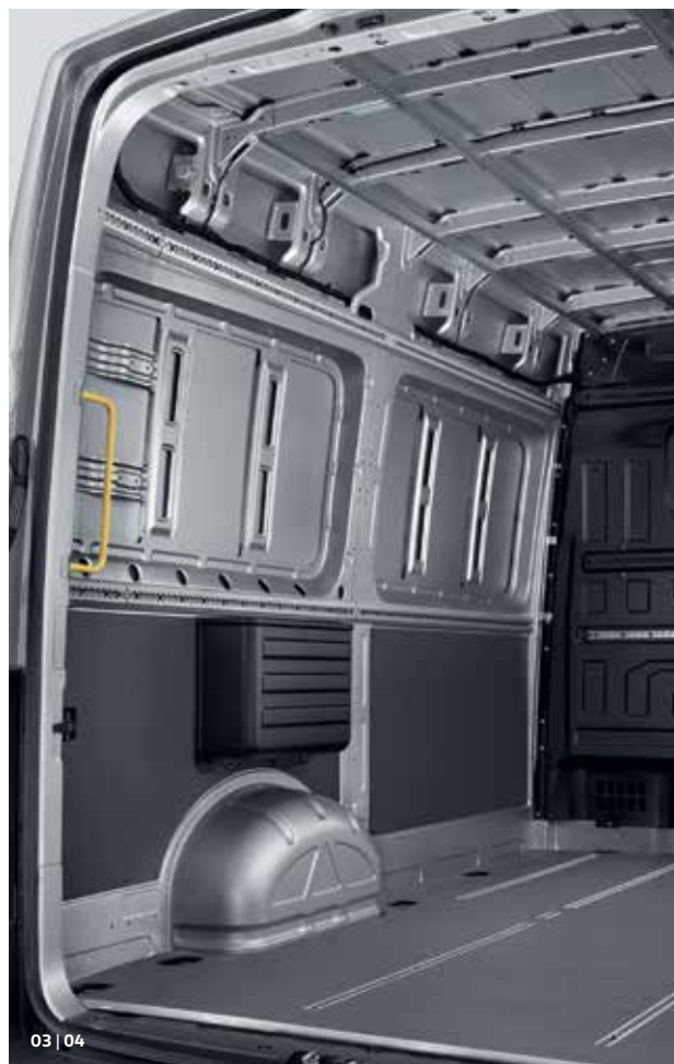
03 Кутии за съхранение над калниците. Те се закрепват в товарното отделение над двата калника и предлагат напр. място за обтягащи колани, инструменти, сигнални жилетки и ръкавици. | KA | PL |
