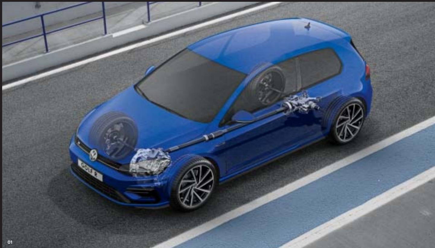
**01** Die elektronisch gesteuerte **Allradkupplung** sorgt bei 4MOTION für die variable Verteilung der Antriebskraft zwischen Vorder- und Hinterachse. Ihre stufenlose Verstellung wird von einem Steuergerät geregelt, das den jeweiligen Schlupf, die fahrdynamischen Zustände und die Antriebsmomente berücksichtigt. **S**
