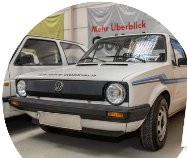
Volkswagen už veľmi dávno testoval aj elektrický pohon. Prototyp Golf City Stromer z roku 1981, vyvinutý v spolupráci s elektrárenským koncernom RWE, poháňal elektromotor BBC (dnes ABB) s výkonom 23 kW, umožňujúci maximálnu rýchlosť 100 km/h. Limitujúcim faktorom bola nielen veľká hmotnosť, ale aj malá kapacita olovených batérií Hagen (dnes Exide) s celkovým napäťom 96 V, ktorá stačila na dojazd iba 60 km. Bola vyrobená iba 25-kusová overovacia séria.
