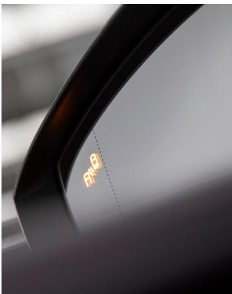
Výstražný LED senzor mŕtveho uhla vo vonkajšom spätnom zrkadle, displej infotainmentu s uhlopriečkou 20,3 cm a rozhrania USB – T-Cross je vybavený najmodernejšou technikou
