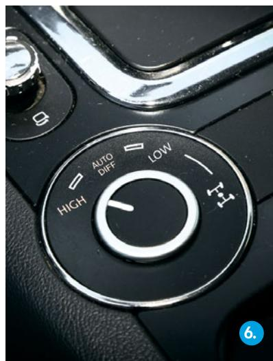
6. Tu sa zapína „offroadovým“ ovládačom redukčná prevodovka a až dve uzávierky diferenciálov. 7. V modeli 7L sa dalo zadné okno otvárať separatne. 8. Tejto verzie motora V6 TDI sa naftový škandál netýka. 9. Hodnotná palubná doska s kvalitnou prístrojkou s farebným displejom a ešte stále použiteľnou navigáciou. 10. Aj starý model jazdí suveréne, jeho hmotnosť však cítiť.
