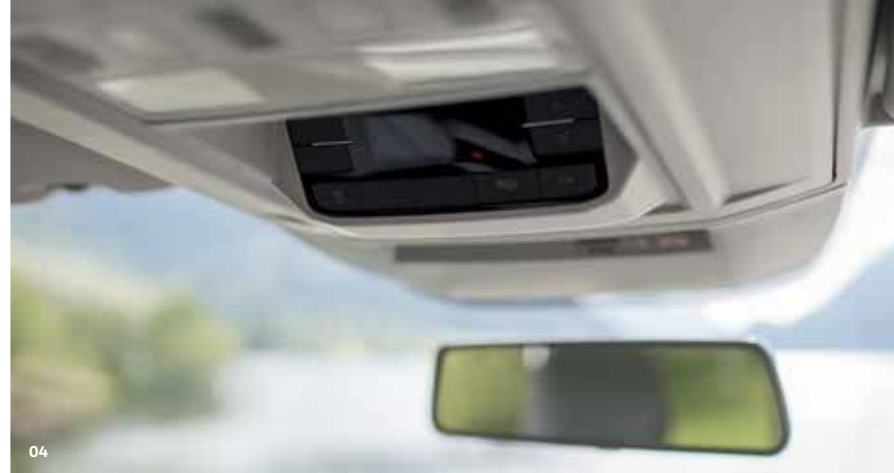
04 Unitate de comandă opțională pentru încălzirea suplimentară. Unitatea de comandă este ușor accesibilă, în panoul din plafon. Ecranul tactil facilitează reglarea și programarea încălzirii suplimentare.
